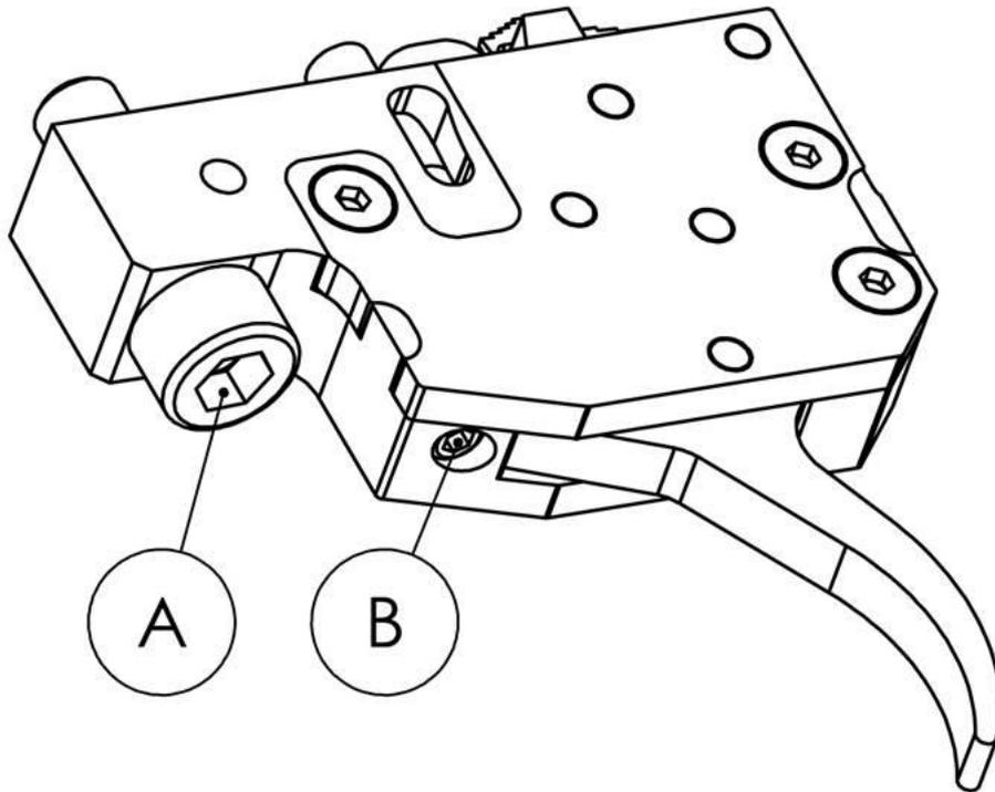
Sie können jetzt noch bei Bedarf das Abzugsgewicht zwischen 450 - 2000 Gramm an der Schraube „B“ einstellen.
