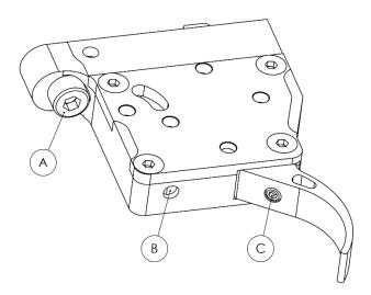
Der Kugelabzug "Barnard P" ist ein einstellbarer Direktabzug. Im Folgenden wird der Einbau, sowie die Auswirkung und Justierung aller Einstellungen durchgegangen. Das Abzugsgewicht kann in gewissen Bereichen verstellt werden. Durch tauschen der Feder (unter der zugehörigen Schraube) kann in andere Verstellbereiche gewechselt werden. Die folgende Tabelle enthält die jeweils zu verwendende Feder (Standardfeder fett gedruckt):
